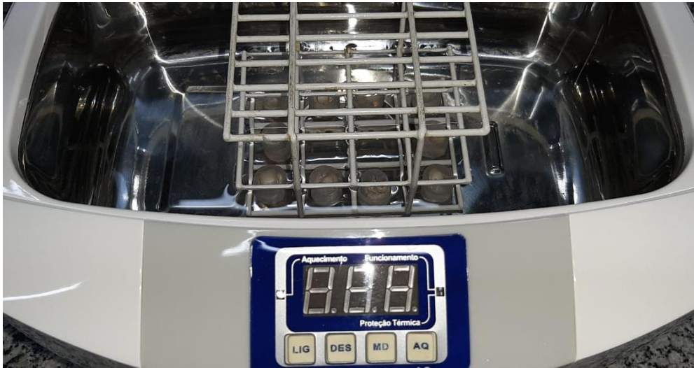
Figura 3 – Lavagem dos corpos de prova em cuba ultrassônica, após a escovação.
