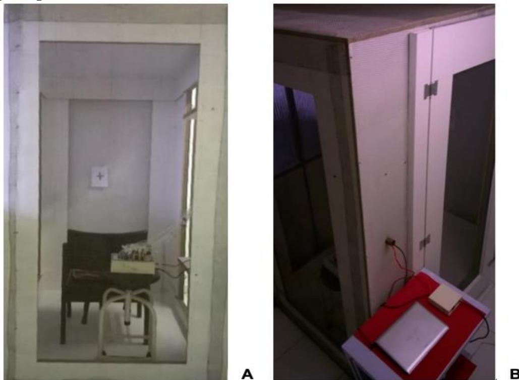
Figura 1 - Gaiola de Faraday. Em A, a gaiola vista lateralmente com a cadeira utilizada pelos voluntários durante a coleta e o aparelho de EEG. Em B, a gaiola vista de cima e o computador para registro do EEG.
