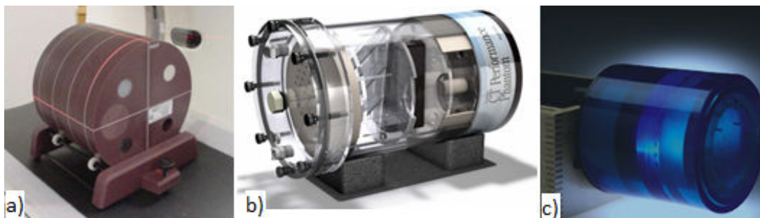
Figura 11 - Fantomas utilizados para controle de qualidade em tomografia multidetector: a) o sugerido pelo ACR; b) o sugerido pela AAPM; c) o Catphan
