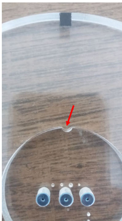
Figura 16- Disco maior e disco menor, a estrutura de encaixe é representada pela seta vermelha.
