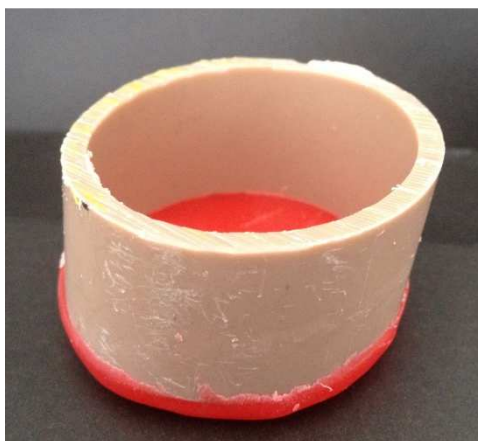
Figura 16 - Tubo de PVC vedado com cera utilidade para inclusão dos dentes Fonte: Dados da pesquisa, 2014.
