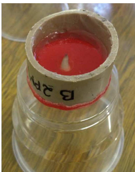
Figura 18 - Conjunto tubo de PVC-dente acomodado em copo plástico para polimerização Fonte: Dados da pesquisa, 2014.
