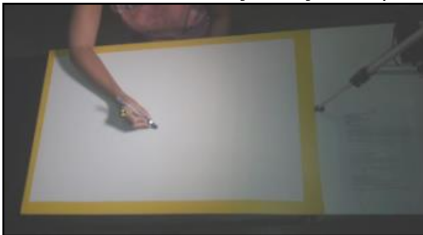
Figura 2: Placa de MDF com espaço delimitado. Caneta Trilux Azul Faber-Castell com fixação do ponto reflexivo e marcador adesivo antialérgico no segundo metacarpo.
