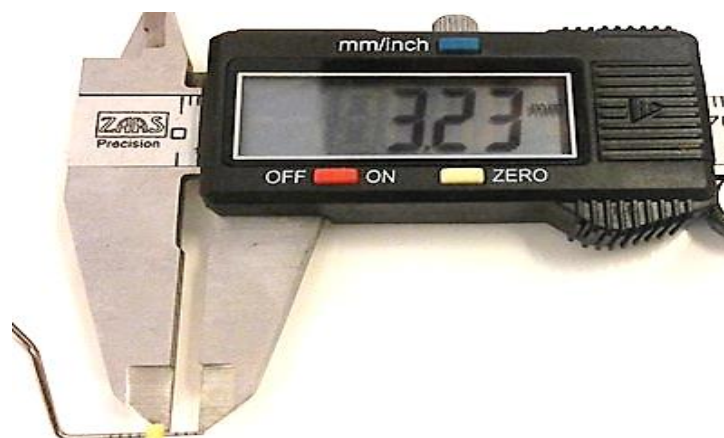
Figura 5 - Obtenção de medida linear através de paquímetro digital.
